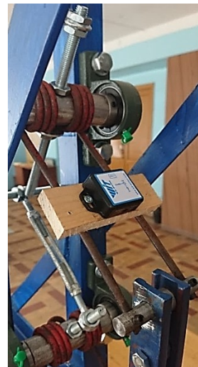
Рис. 2. Лабораторная установка для исследования экспериментального образца сошниковой группы: а, б – общий вид; в – регистрирующий датчик WitMotion WT901WIFI MPU9250: 1 – рама; 2 – стойка рамы; 3 – опора подшипниковая; 4 – звено механизма подвеса с кронштейном крепления; 5 – прицеп пружины кручения; 6 – ось; 7 – механизм регулировки угла поворота оси /
