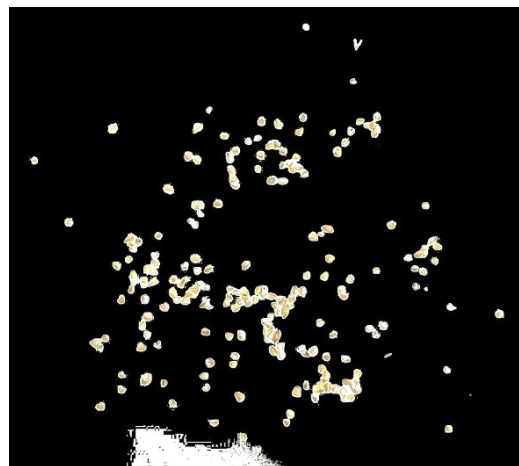
Рис. 2. Маска, построенная для изображения на рисунке 1 с помощью метода цветовой сегментации в Lab пространстве /
