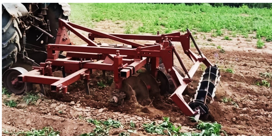
Рис. 3. Агрегат МПА-2,2/3,0 с рабочими органами: а – для основной обработки и прутковым катком; б – для мелкой обработки почвы и планчато-зубчатым катком при проведении опытов
