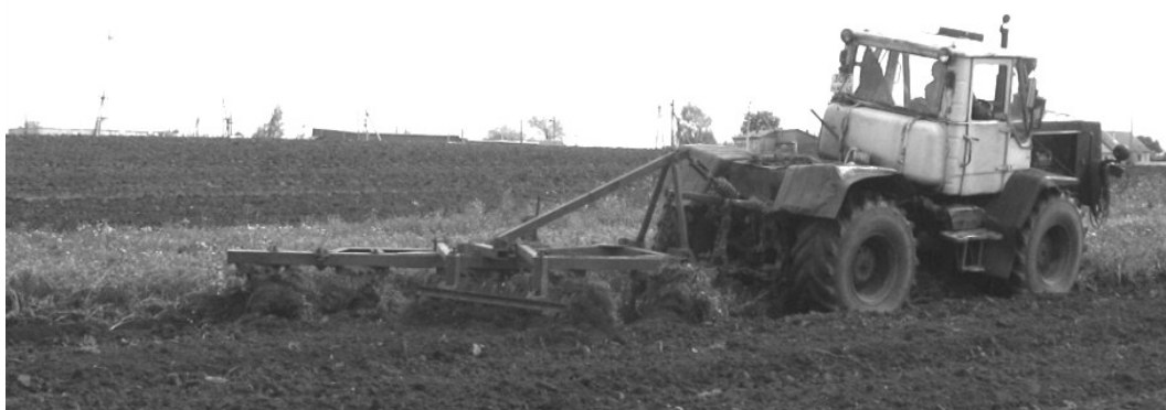
Рис. 2. Общий вид плуга-плоскореза ППН-4(5)-35/3-70 при комплектации 5 плужными корпусами и дисковой секцией: а - вид справа; б – в процессе работы с трактором Т-150К
