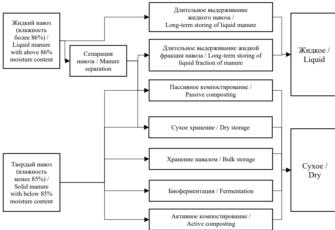
Рис. 2. Схема соотнесения типа навоза к типу хранения / Fig. 2. Scheme for correlating the type of manure to the type of storage
