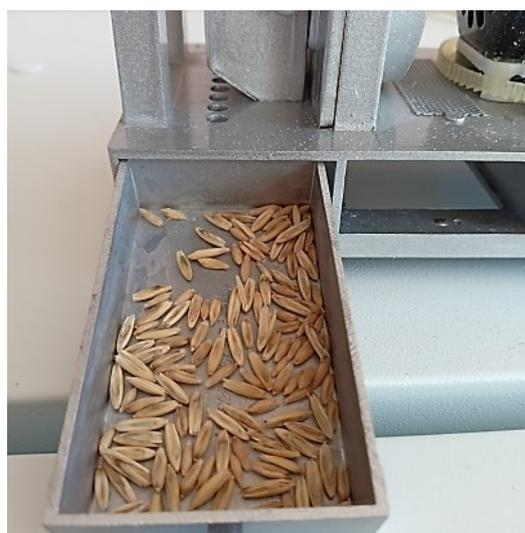
*Рис. 2. Шелушитель зерна «МИНИ» / Fig. 2. "MINI" grain husker*
