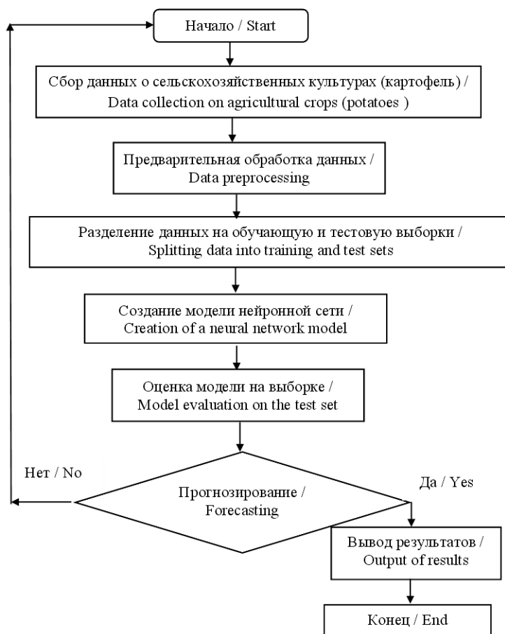
Рис. 1. Алгоритм работы программы ЭВМ на Python для прогнозирования урожайности картофеля с использованием нейронных сетей /
