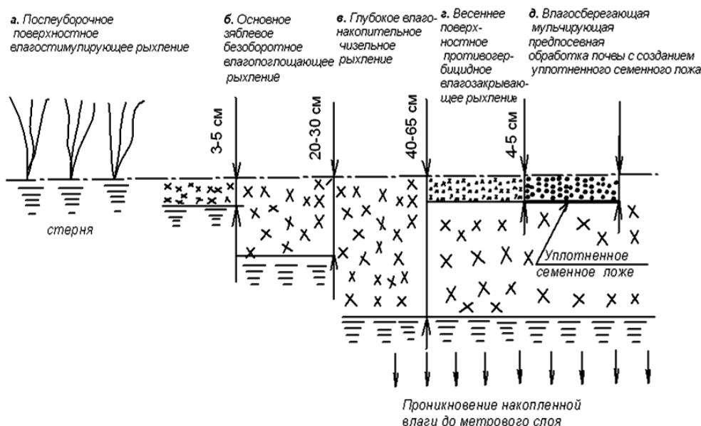
Рис. 2. Содержание влагонакапливающей технологии обработки почвы (Патент РФ №2457651 от 16.02.2011) /
