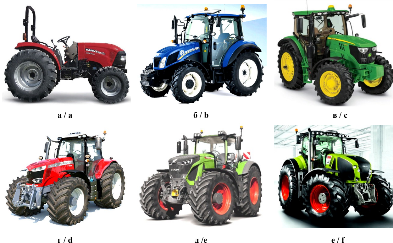
Рис. 2. Современные образцы колесных тракторов разного тягового класса некоторых ведущих производителей разной мощности: а – 50 л. с, б – 75 л. с, в – 150 л. с., г – 250 л. с, д – 350 л. с., е – 450 л. с. /
