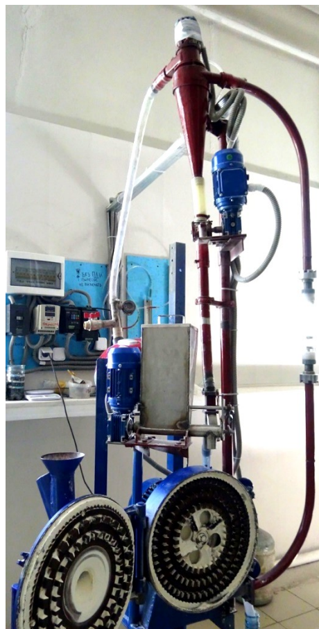
Рис. 1. Схема и фото установки ПДУ-380 для измельчения и пневмокласификации муки: 1 – диспергатор, 2 – патрубок загрузки муки, 3 – воздуховод, 4 – циклон, 5 – классификатор, 6 – электродвигатель, 7 – фильтр, 8 – шлюзовый затвор, 9 – клапан перекидной, 10 – сборник тяжелой фракции, 11 – сборник легкой фракции /
