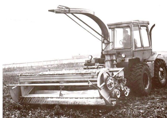
Рис. 7. Варианты кормоуборочных комбайнов на базе трактора «интегральной схемы» (трактор на реверсе) /
