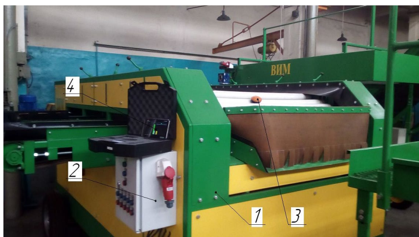
Рис. 3. Общий вид лабораторной установки по определению места и уровня повреждений корнеплодов: 1 – сортировальная машина; 2 – шкаф управления; 3 – регистратор данных; 4 – планшетный компьютер /
