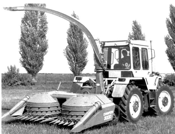
Рис. 7. Варианты кормоуборочных комбайнов на базе трактора «интегральной схемы» (трактор на реверсе) /
