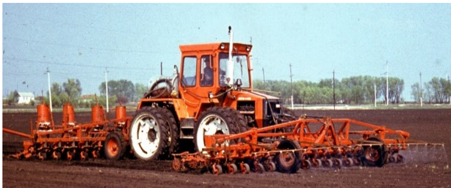
Рис. 5. Комбинированный 18-рядный агрегат на предпосевной обработке почвы, полосном внесении гербицида и посеве сахарной свеклы на базе трактора «интегральной схемы» /
