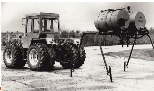
Установка емкостей подкормщика-опрыскивателя на технологическую площадку трактора «интегральной схемы» / Installation of feeder-sprayer tanks on the technological platform of the «integrated circuit» tractor
