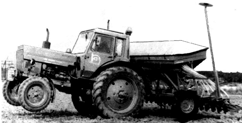
Рис. 2. Потеря продольной устойчивости и управляемости трактора «классической» компоновочной схемы MTZ-80 при агрегатировании с навесной зерновой сеялкой фирмы Kverneland Accord /
