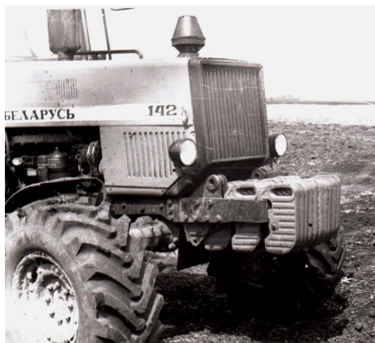
Рис. 3. Балластный груз массой 600 кг на тракторе MTZ-142 /
