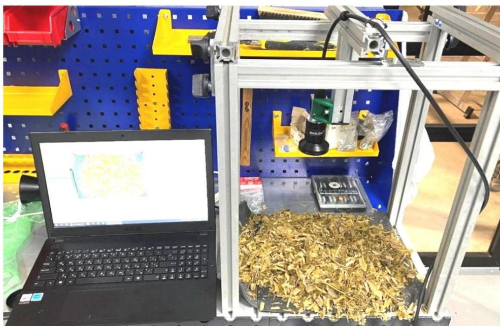
*Рис. 1. Экспериментальная установка для диагностики кормов с системой технического зрения / Fig. 1. Experimental installation with a vision system for the diagnosis of feed*
