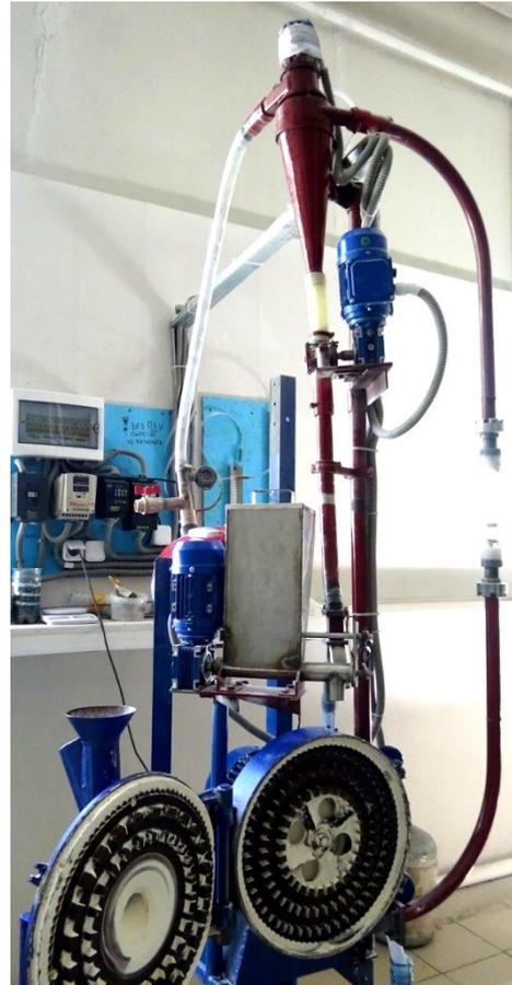
Рис. 1. Схема и фото установки ПДУ-380 для измельчения и пневмокласификации муки: 1 – диспергатор, 2 – патрубок загрузки муки, 3 – воздуховод, 4 – циклон, 5 – классификатор, 6 – электродвигатель, 7 – фильтр, 8 – шлюзовый затвор, 9 – клапан перекидной, 10 – сборник тяжёлой фракции, 11 – сборник лёгкой фракции /
