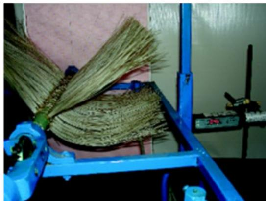
**Рис. 1. Схема (а) и общий вид (б) лабораторной установки для определения упругости лопастей ротора и процесса работы: 1 – рама; 2 – лопасти; 3 – цифровой динамометрический ключ; 4 – штатив / Fig. 1. Schematic (a) and general view (b) of a laboratory installation for determining the elasticity of the rotor blades and the operation process: 1 – frame; 2 – blades; 3 – digital torque wrench; 4 – tripod**
