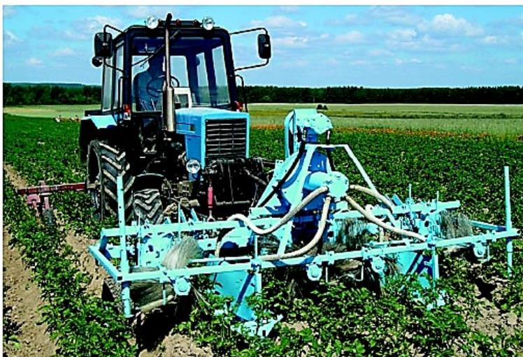
Рис.4. Комбинированный агрегат для сбора колорадского жука и окучивания картофеля в работе /
