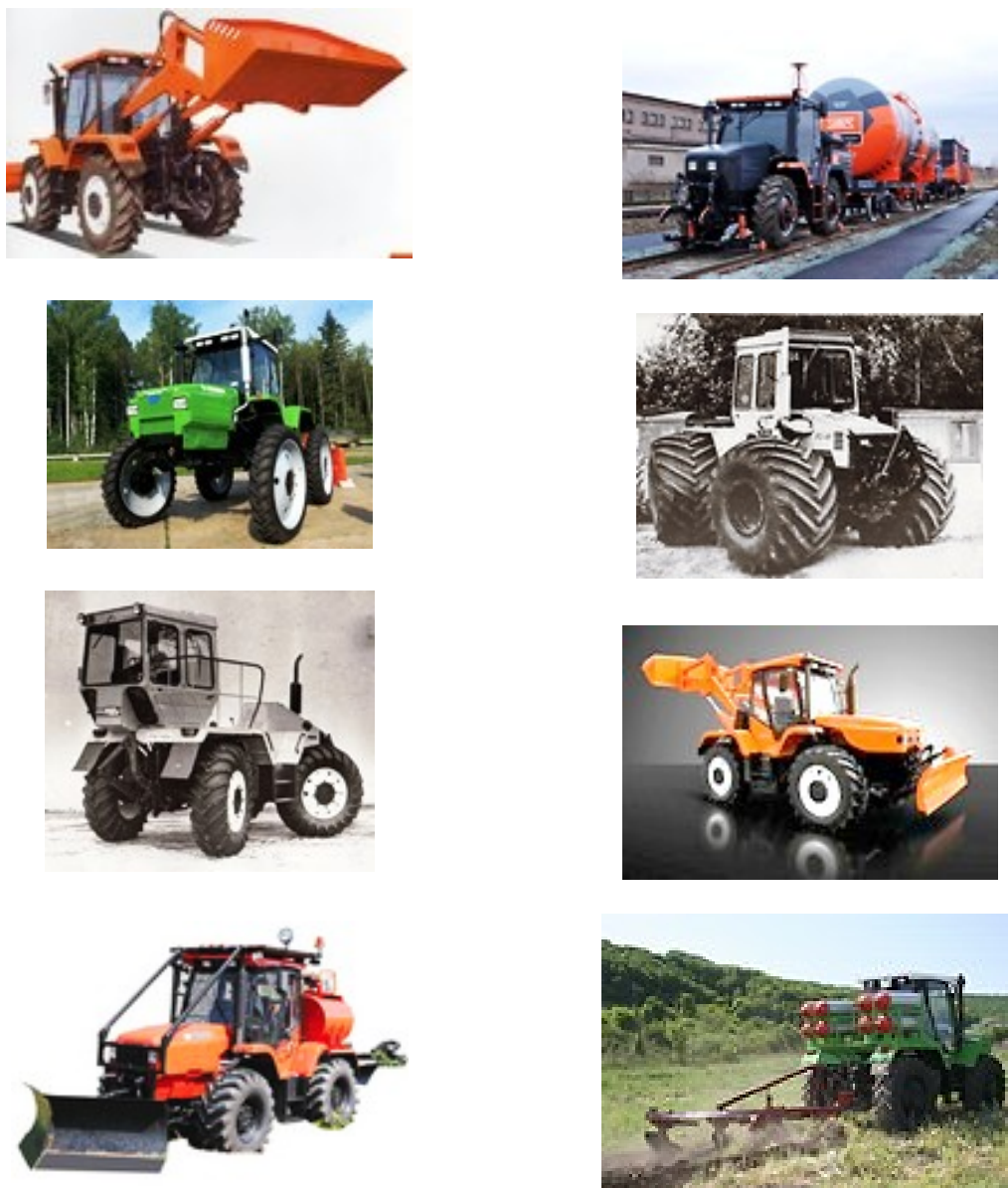
Рис. 5. Модификации трактора на базе «интегральной» схемы / Fig. 5. Modifications based on the "integrated" circuit of the tractor
