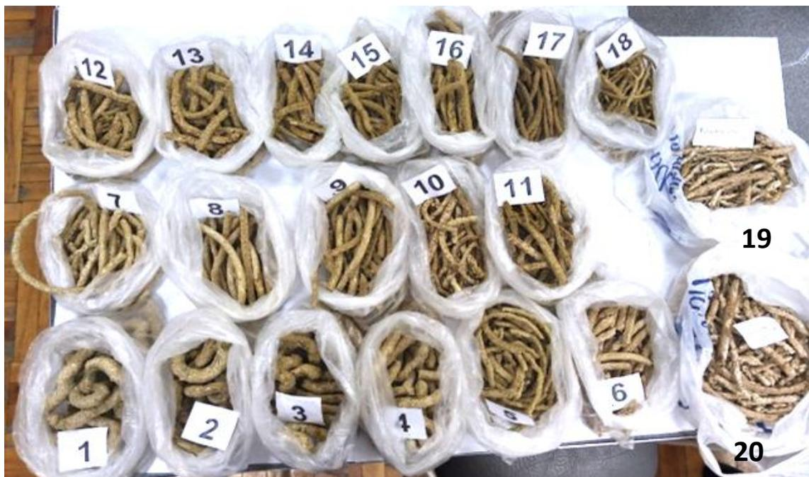
*Рис. 2. Образцы экструдата из зерна пшеницы и биомассы личинок черной львинки (вариант II: биомасса личинок 12,5 % + зерно пшеницы 87,5 %), полученный при температуре: 1, 2 – 115 °С; 3, 4 – 118 °С; 5, 6 – 121 °С; 7, 8 – 124 °С; 9, 10 – 127 °С; 11, 12 – 130 °С; 13, 14 – 132 °С; 15, 16 – 135 °С; 17, 18 – 138 °С; 19, 20 – экструдат только из пшеницы, полученный при температуре 124 °С (контрольный образец)*
