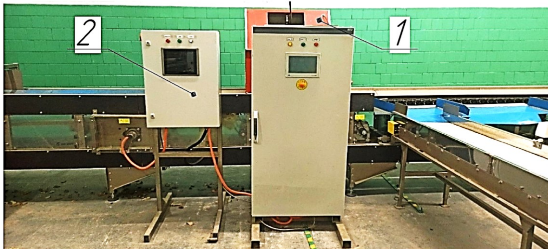
Рис. 8. Система технического зрения линии сортировки ЛСП-4: 1 – оптический модуль с видеокамерой и структурной подсветкой; 2 – электронный блок управления /
