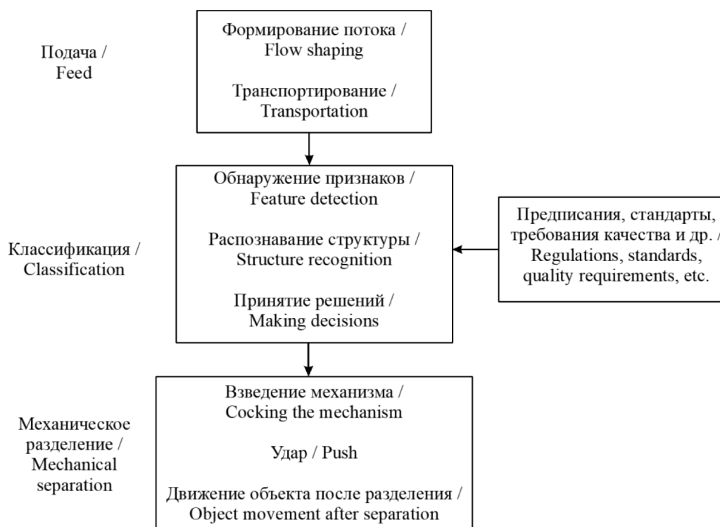
Рис. 2. Функциональная схема системы сортировки плодов по качеству / Fig. 2. Functional diagram of the system for sorting fruits by quality
