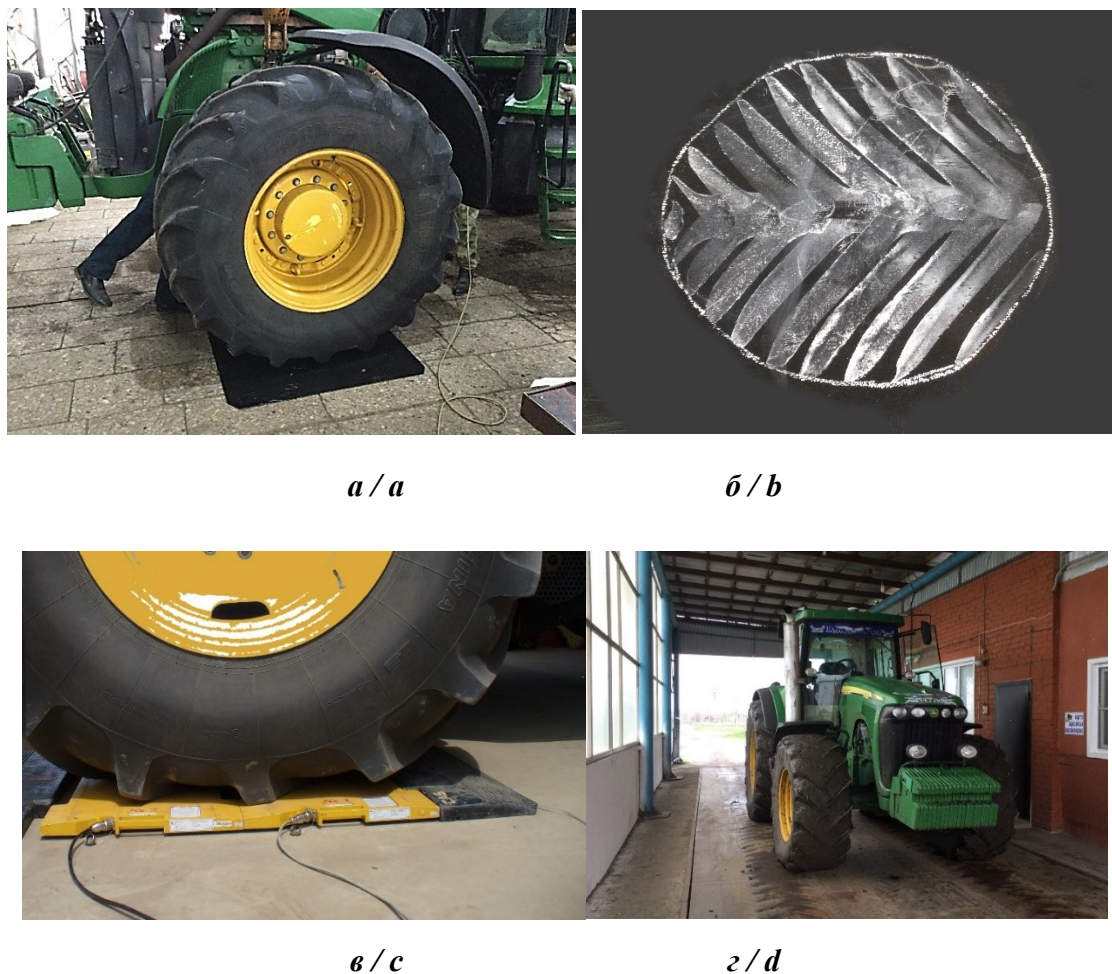
Рис. 1. Определение размеров контактирующей поверхности шин (а, б), процесс взвешивания трактора (в, г) /
