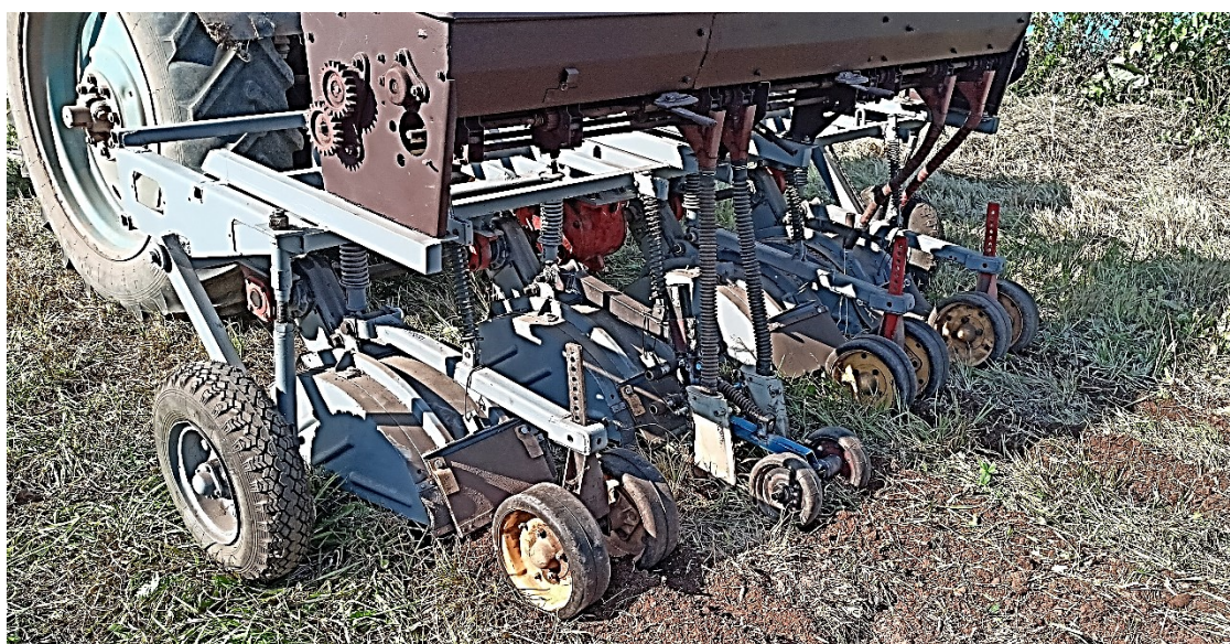
Рис. 3. Опытный образец дернинной сеялки СДК-2,8М при проведении исследований сошниковых групп в полевых условиях /
