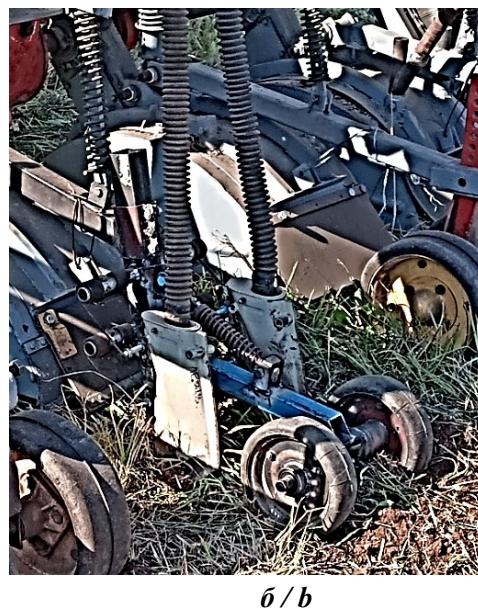
Рис. 2. Опытный образец сошниковой группы сеялки полосного посева семян трав в дернину: а – общая схема, б – при проведении испытаний: 1 – грядиль; 2 – рама крепления; 3 – сектор регулировочный; 4 – сошник; 5 – каток; 6 – поводок; 7 – штанга нажимная; 8 – механизм регулировки положения сошника; 9 – пружина кручения; 10 – кронштейн крепления /
