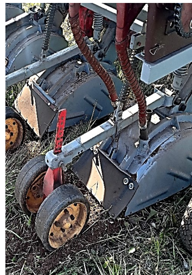
Рис. 1. Сошниковая группа сеялок СДК (ОАО ВМП «Авитек», г. Киров) полосного посева семян трав в дернину: а – общая схема, б – при проведении испытаний: 1 – грядиль; 2 – тукопровод; 3 – семяпровод; 4 – штанга нажимная; 5 – кронштейн катков; 6 – каток; 7 – семянаправитель; 8 – туконаправитель; 9 – кожух; 10 – фреза дисковая /
