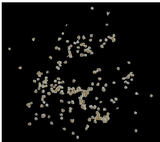
Рис. 5. Маска, полученная из бинарного изображения на рисунке 4 после удаления малых связных областей и дыр /
