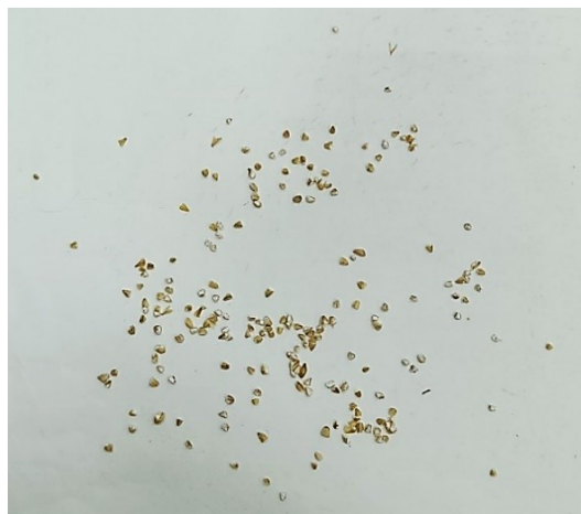
Рис. 1. Изображение с соприкасающимися частицами измельченного зерна разной формы / Fig. 1. An image with touching particles of crushed grain of different shapes
