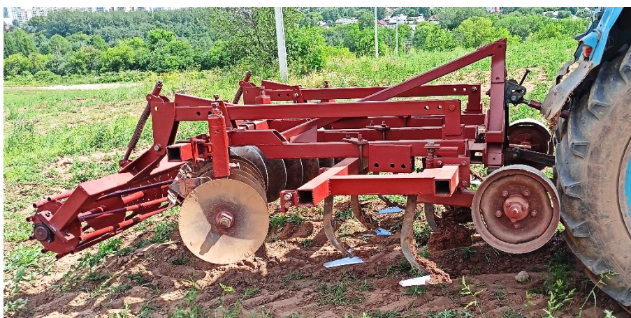
Рис. 2. Агрегат МПА-2,2/3,0 с рабочими органами: а – для основной обработки и трубчатым катком; б – для мелкой обработки почвы и спирально-трубчатым катком при проведении опытов /
