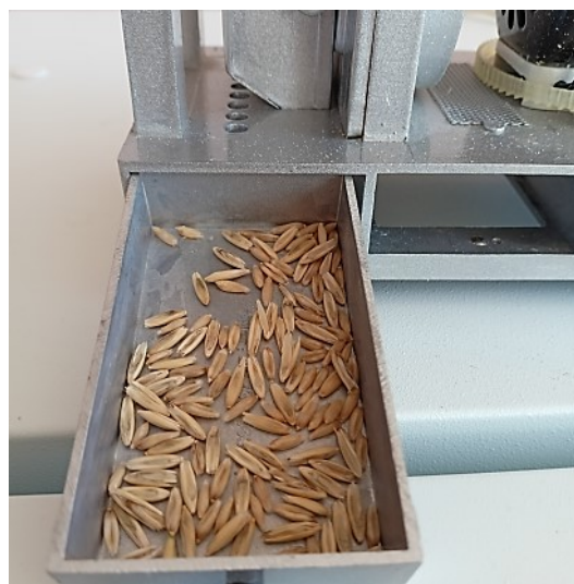
Рис. 2. Шелушитель зерна «МИНИ» / Fig. 2. "MINI" grain husker
