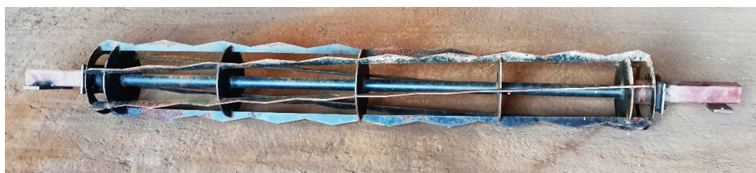
Рис. 1. Сменные адаптеры (катки) для обработки верхнего слоя почвы: а – трубчатый; б – спирально-трубчатый; в – прутковый; г – планчато-зубовый /
